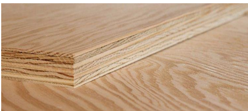
รูปที่ 2.8 ไม้อัด 14x14 / ไม้ 2 เมตร
