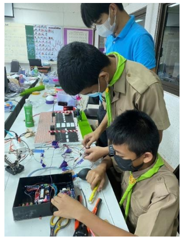
รูปที่ 5 ภาพแสดงขั้นตอนติดตั้งอุปกรณ์ สายไฟ และเซ็นเซอร์ตรวจจับการเคลื่อนไหวบนแผงบอร์ด Kid Bright
