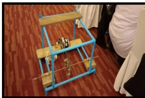
ภาพที่ 3.22 ทำฐานรองเพื่อที่จะตั้งมอเตอร์ DC และอื่นๆ
