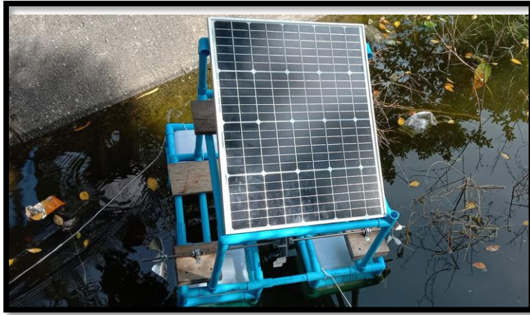
ภาพที่ 3.26 นำเครื่องบำบัดน้ำเสียจากพลังงานแสงอาทิตย์ไปทดสอบในแหล่งน้ำเสีย
