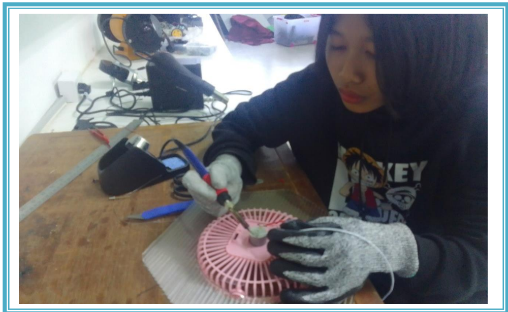
นักเรียนบัดกรีพัดลมระบายอากาศ
