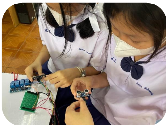
3. ต่อเซนเซอร์ และอุปกรณ์เข้าอัลตราโซนิก (Ultrasonic Sensor) กับบอร์ด ESP32
