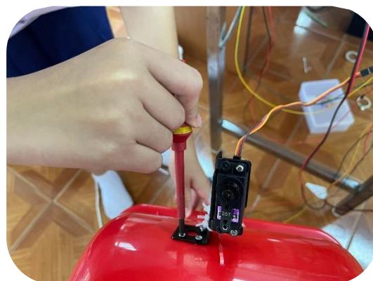
4. ต่อมอเตอร์เซอร์โวเข้ากับบอร์ด ESP32 และติดตั้ง เข้ากับฝาถังขยะ
