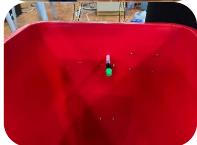
7. ติดตั้งหัวพ่นสเปรย์เข้ากับสายยาง และต่อเข้ากับปั้มน้ำแรงดันสูง
