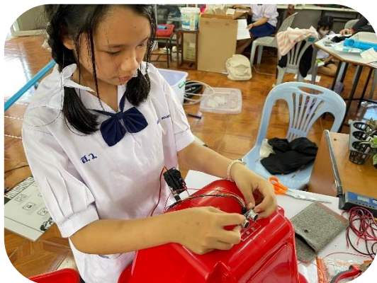
5. ติดตั้งเซนเซอร์อัลตราโซนิก (Ultrasonic Sensor) เข้ากับตัวถังขยะ
